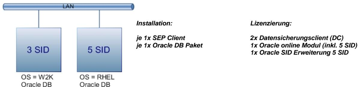
In der dargestellten Umgebung mit zwei Oracle Datenbank Rechnern kann das jeweilige Betriebssystem auch unterschiedlich sein, gemäß der unterstützten Plattformen. Um die Datenbanken zu sichern wird jeweils ein SEP Client (Basiskommunikation mit SEP sesam Server) und ein Oracle Installationspaket installiert.
