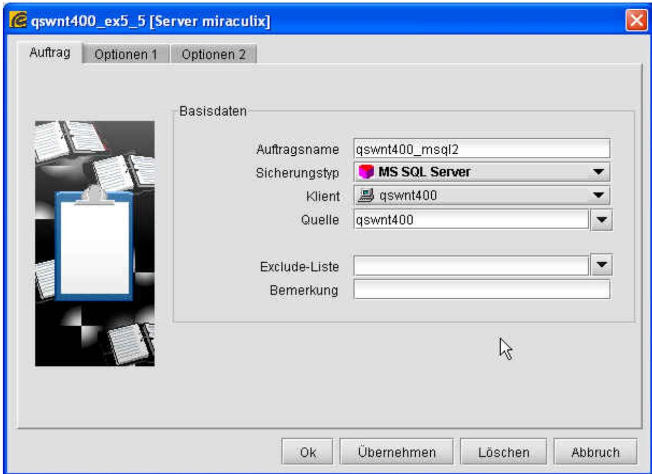
Nach dem Eintrag eines Auftragsnamens (hier qswnt400\_msq12), wird der Sicherungstyp **MS SQL Server** und der Klient ausgewählt, auf dem sich die MS-SQL-Datenbank befindet (hier qswnt400). Als Quelle wird der Name, der auch vom MS-SQL-Server angezeigt wird, eingesetzt (hier myxxxxdb).
